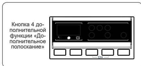
В конце выбранной программы стирки с помощью этой дополнительной функции вы можете добавить дополнительную операцию полоскания. Чтобы выбрать эту функцию, нажмите кнопку «Дополнительное полоскание», когда отображается символ
