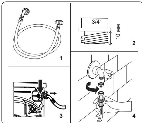
1. Ваша машина имеет одно подключение к линии водопровода (с подводом холодной воды). Шланг с белым наконечником предназначен для подключения к линии холодного водоснабжения. .
