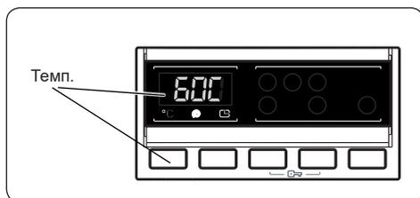
Чтобы изменить автоматически запрограммированную температуру воды для стирки, воспользуйтесь кнопкой регулировки температуры воды.
