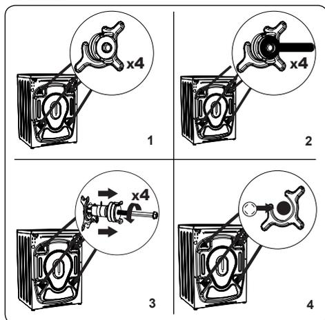
1. Перед использованием стиральной машины необходимо удалить 4 транспортировочных болта и резиновые прокладки в задней части машины. Если болты не удалены, они могут вызвать сильную вибрацию, шум и выход машины из строя, а также привести к аннулированию гарантии.
