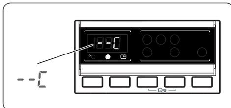
Если вы пропустили желаемую температуру воды для стирки, продолжайте нажимать кнопку регулировки температуры воды, чтобы снова найти нужную температуру.
