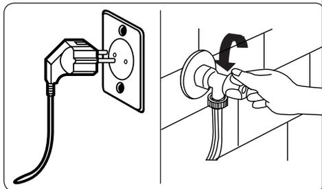
Прежде чем приступить к техническому обслуживанию и чистке машины, отключите электропитание и выньте вилку из розетки.
